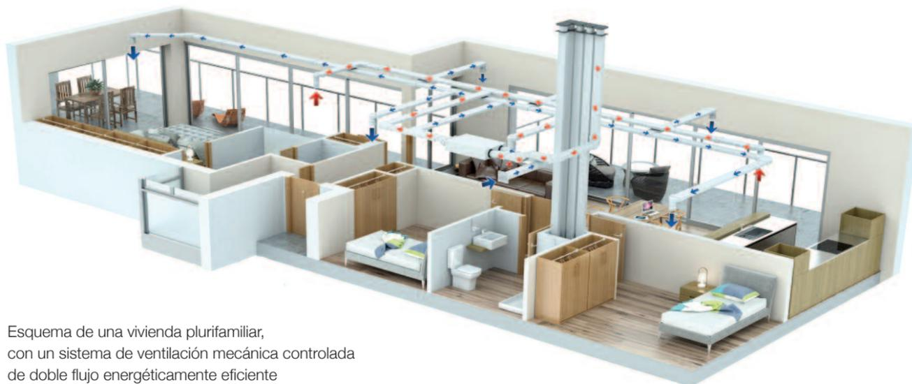
Esquema de una vivienda plurifamiliar, con un sistema de ventilación mecánica controlada de doble flujo energéticamente eficiente
